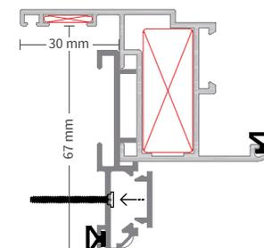
Z da 30 mm con allargatore telaio
