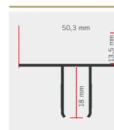
staffa di fissaggio riscontro a muro e guida superiore (di serie, per fissaggi frontali)
