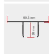
staffa di fissaggio guida laterale (per fissaggi laterali)
