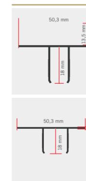
staffa di fissaggio riscontro a muro e guida superiore (di serie, per fissaggi frontali)
