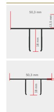
staffa di fissaggio riscontro a muro e guida superiore (di serie, per fissaggi frontali)
